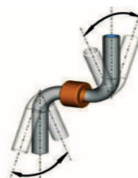
Typ 13S Vridrörelse på båda sidor med typ 13S i rakt rörstycke
